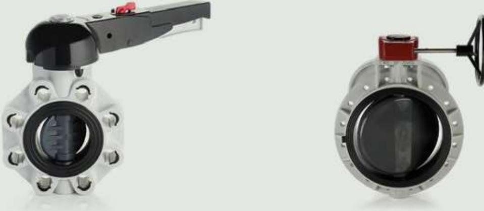
Βαλβίδα πεταλούδας τύπου Wafer, διαμπερούς ατράκτου, με εναλλάξιμο δίσκο PP-H και σώμα από ομοπολυμερές πολυυπροπυλένιο PP-GF κατά ASTM D-4101, σχεδιασμένη για θερμοκρασίες λειτουργίας από 0°C έως 90°C. Η βαλβίδα PP είναι ανεπηρέαστη από αλκάλια, άλατα, οργανικούς διαλύτες και τα περισσότερα οξέα, ιδιαίτερα υδροχλωρικό και φωσφορικό οξύ. Είναι ακατάλληλη για ισχυρά οξέα, χλωριωμένους υδρογονάνθρακες, αρωματικές ενώσεις και υψηλές συγκεντρώσεις ελεύθερου χλωρίου.
